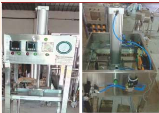
चित्र 2: पनीर प्रेसिंग हेतु स्वचालित मशीन क) फ्रंट पैनल ख) आंतरिक संरचना
